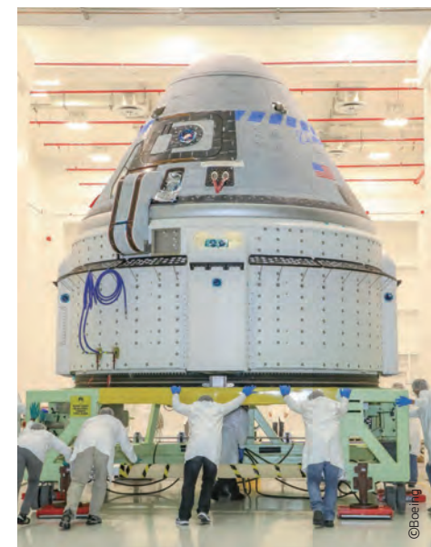
위쪽의 원뿔 부분이 지구로 귀환하는 크루 모듈(재사용 가능 캡슐)이며 아래쪽의 원통 부분은 궤도 기동 및 자세 제어 추진기와 연료, 정비 등을 탑재한 서비스 모듈이다.
